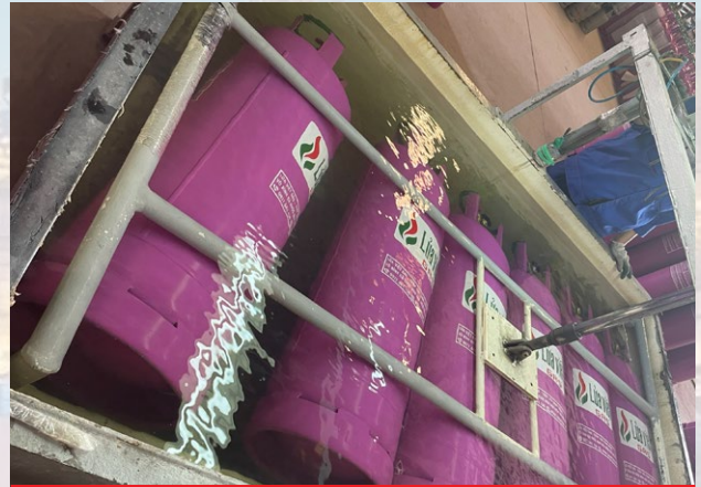
VỎ BÌNH ĐƯỢC KIỂM ĐỊNH AN TOÀN TRƯỚC KHI ĐƯA VÀO SỬ DỤNG Gas cylinders are tested for safety before being put into use
